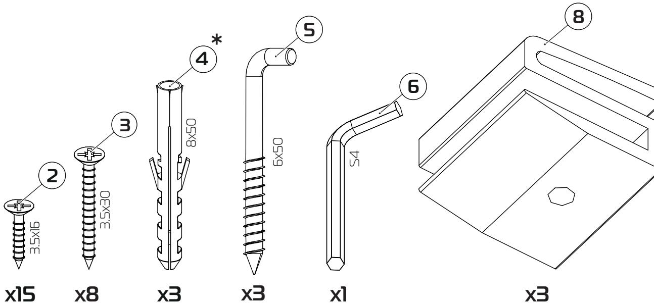
\* Дюбель подходит для стен из кирпича и бетона
